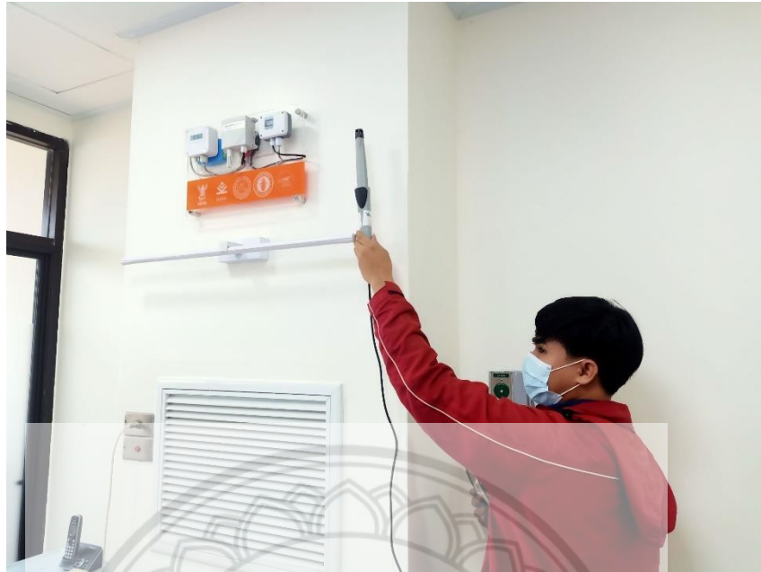
รูปที่ ง.15 การทดสอบความแม่นยำของชุดเซนเซอร์ตรวจวัดคุณภาพ
