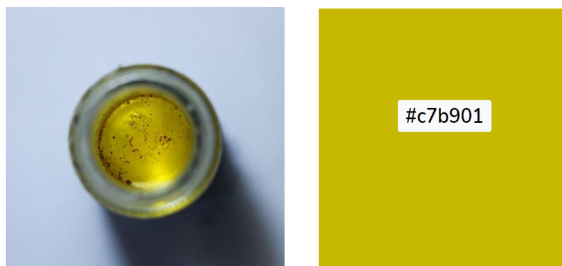
รูปที่ 4.37 สีของน้ำมัน โดยใช้ความดัน 25 เมกะปาสคาล และกำลังไฟ 400วัตต์ เป็นเวลา 3 นาที
