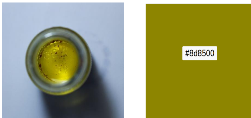
รูปที่ 4.24 สีของน้ำมัน โดยใช้ความดัน 15 เมกะปาสคาล และกำลังไฟ 600วัตต์ เป็นเวลา 7 นาที
