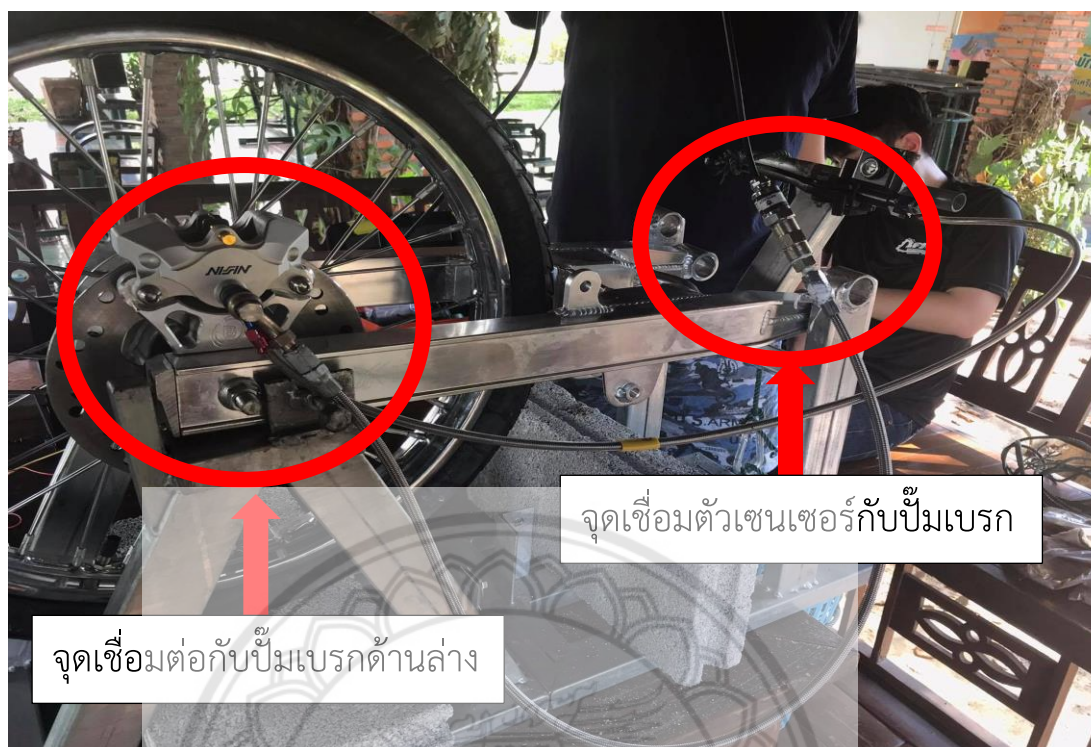
รูปที่ 3.1 การติดตั้งเซนเซอร์ความดัน
