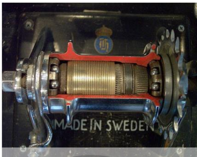
รูปที่ 2.6 แบบโคสเตอร์เบรก (ที่มา :สิทธิทา ทองมี, 2020)
