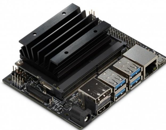
รูปภาพที่ 2.9 บอร์ด NVIDIA Jetson Nano Developer Kit (ที่มา : https://www.arduitronics.com/product/2606 )
