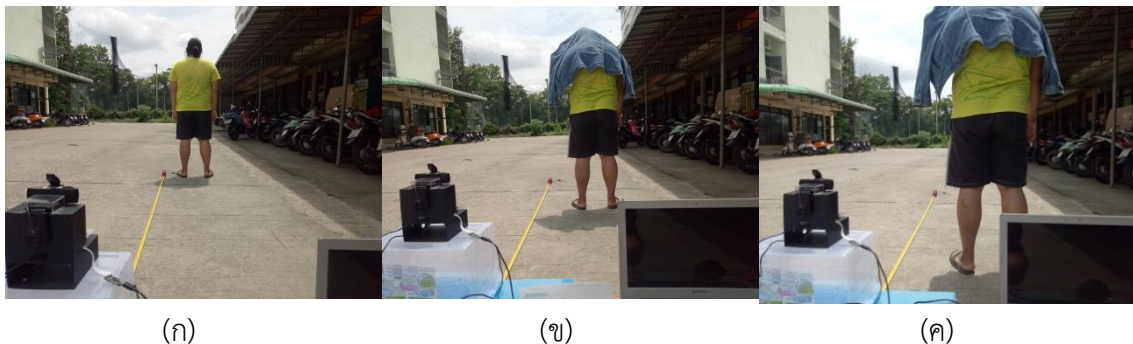
รูปภาพที่ 4.10 การทดสอบอัลกอริทึมที่มีการแจ้งเตือน ระยะห่าง 1000 mm (ก) ระยะห่าง 2000 mm (ข) ระยะห่าง 3000 mm (ค)
