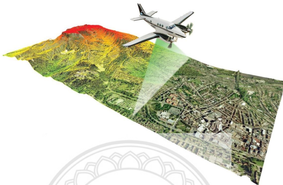
รูปภาพที่ 2.4 การจำลอง lidar สำหรับงานสำรวจภูมิประเทศ (ที่มา : https://thematter.co/science-tech/meet-lidar-revealed-cambodia-lost-city/4052/,2559 )
