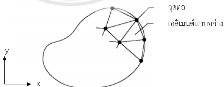
รูปที่ 2.18 การแบ่งรูปร่างลักษณะของปัญหาออกเป็นเอลิเมนต์ย่อย [7]
