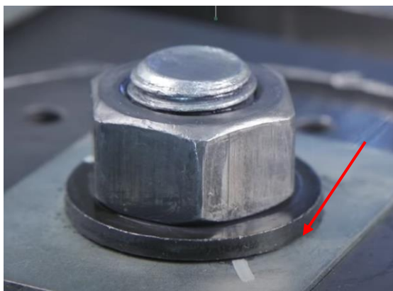
รูปที่ 2.24 ตัวอย่าง Contact Type ชนิด Separation [21]
