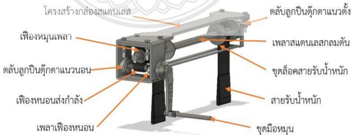
รูปที่ 2.6 ชุดกลไกยกผู้ป่วยของ Limo PTS รุ่น 2 [4]
