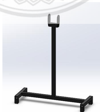
รูปที่ 3.12 ออกแบบฐานยึดรถจักรยานยนต์ด้านหน้า
