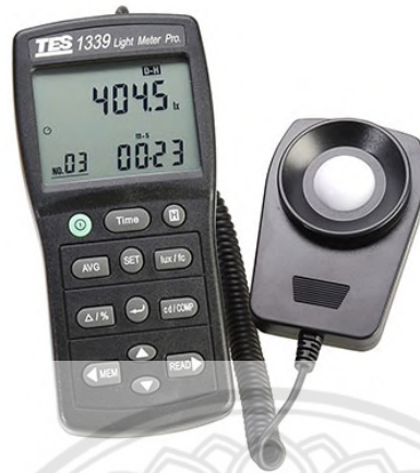
รูปที่ ค.8 อุปกรณ์วัดค่าส่องสว่าง Lux Meter
