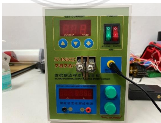
รูปที่ 3.14 เครื่องเชื่อมจุดจ่ายกำลังไฟ
