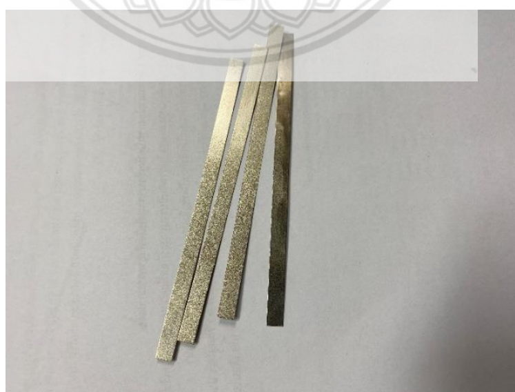
รูปที่ 3.5 แผ่นนิกเกิลเชื่อมแบตเตอรี่
