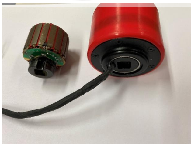
รูปที่ 3.2 มอเตอร์ไฟฟ้ากระแสตรงแบบไม่มีแปรงถ่าน (Brushless DC Motor)
