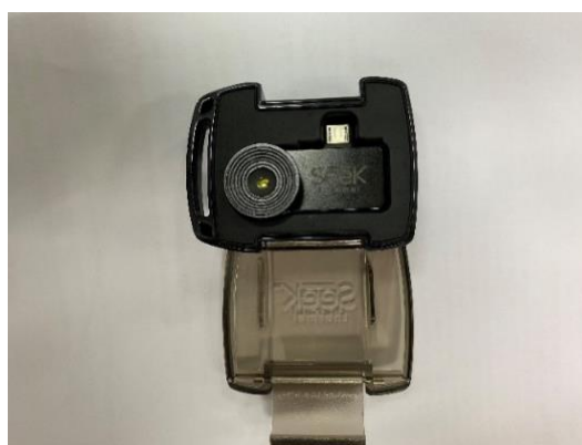
รูปที่ 3.20 เลนส์กล้องตรวจวัดอุณหภูมิ SEEK Thermal COMPACT XR สำหรับ Android
