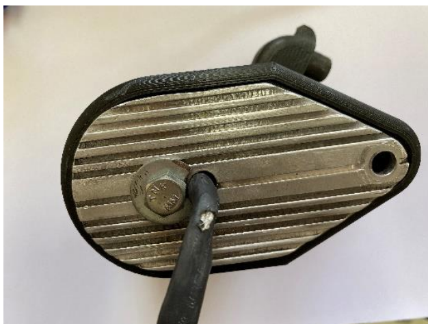
รูปที่ 3.13 แผ่นระบายความร้อนที่พัฒนาแล้วแบบมีครีป
