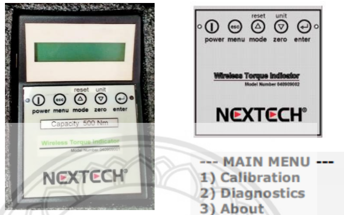
รูปที่ 2.13 ตัวแสดงค่าแรงบิดที่เกิดจากทอร์คเซนเซอร์
