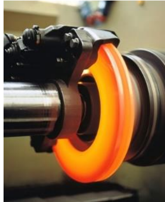
รูปที่2.9 เบรกเฟดที่เกิดจากแรงเสียดทาน(Friction Fade)
