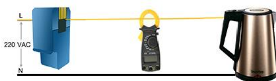
รูปที่ 3.16 การทดสอบเซ็นเซอร์วัดกระแสไฟฟ้า
