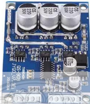
รูปที่ 3.12 บอร์ดควบคุมมอเตอร์แบบไร้แปรงถ่าน Hall BLDC DRIVER BOARD DC 12-36 V 15A 500 W
