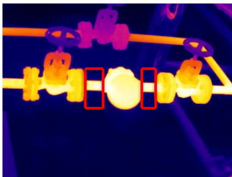
รูปที่ 4.5 ตัวอย่างกับดักไอน้ำที่มีการรั่วไหล (สีของอุณหภูมิจากภาพถ่ายความร้อนที่ตำแหน่งทางเข้าและทางออกมีความใกล้เคียงกัน)
