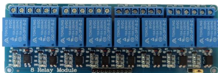
รูปที่ 2.7 แผงวงจรรีเลย์แบบใช้ตัวเชื่อมต่อด้วยแสง
