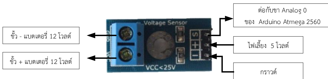
รูปที่ 3.3 การเชื่อมต่อใช้งานตัวรับรู้แรงดัน
