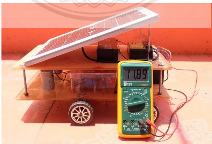
รูปที่ 4.3 การวัดและบันทึกค่า การทดสอบการอัดประจุแบตเตอรี่
