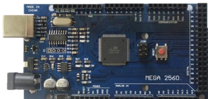
รูปที่ 2.1 แผงวงจรด้านหน้าของบอร์ดไมโครคอนโทรลเลอร์อาตูดิวโน รุ่น AT mega 2560 R3 ที่มา: https://www.thaieasyelec.com
