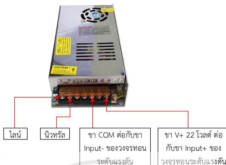
รูปที่ 3.18 การต่อใช้งานหม้อแปลงสวิตซ์ซิ่ง
