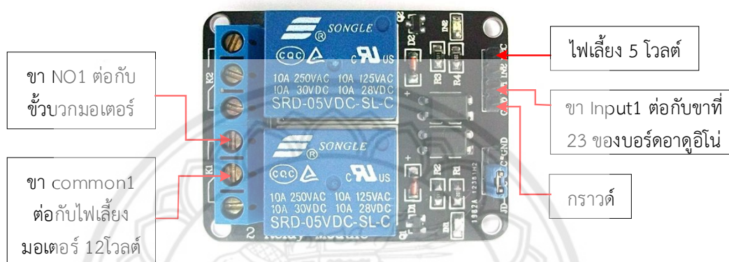
รูปที่ 3.9 การต่อใช้งานแผงวงจรรีเลย์ 2 ช่อง
