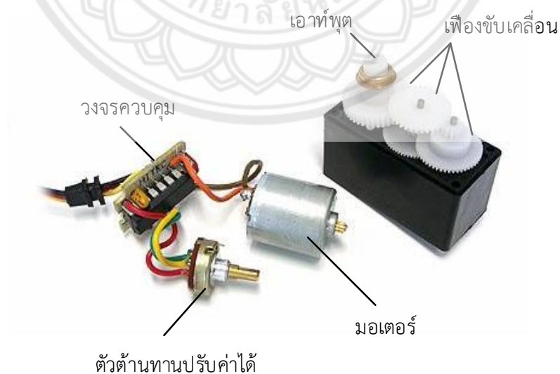
รูปที่ 2.6 องค์ประกอบหลักของมอเตอร์เซอร์โว
