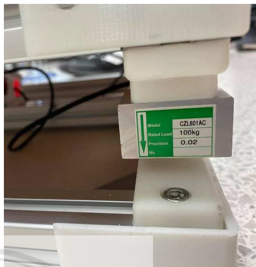
ข. Loadcell ที่รับน้ำหนักสูงสุด100 kg
