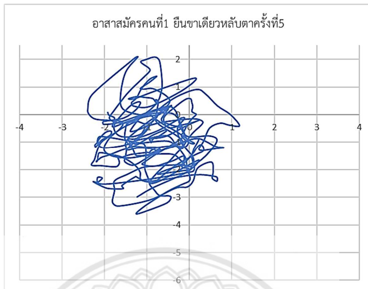
รูปที่ ข.20 กราฟแสดงการเคลื่อนตัวของจุดCOPของอาสาสมัครคนที่1 ในการยืนขาเดียวหลับตาครั้งที่5
