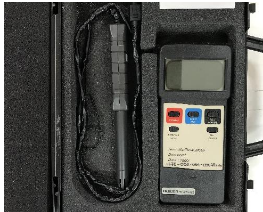
รูปที่ 4.4 เครื่องวัดความชื้นและอุณหภูมิอากาศ ยี่ห้อ Digicon รุ่น HT-775-232
