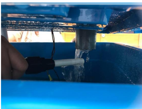
รูปที่ 4.1 การวัดอุณหภูมิบริเวณที่รวบรวมสารละลายธาตุอาหาร
