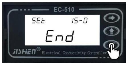
รูปที่ 5ข. หน้าจอ menu setting 15-0 เพื่อจบการทำงาน
