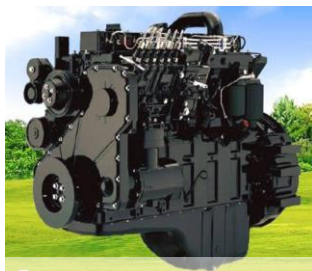
รูปที่ 2.6 เครื่องยนต์ต้นกำลังของเครื่องเกี่ยวขนาดข้าว
