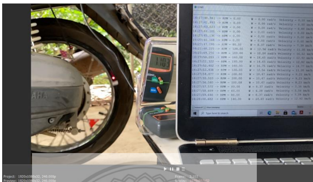
รูปที่ ก.5 เซนเซอร์ตรวจพบแม่เหล็กตัวที่ 4 ณ เฟรม 2,103
