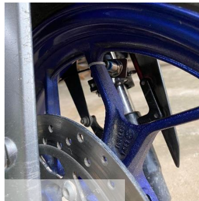
รูปที่ จ.19 การติดตั้งเซนเซอร์แม่เหล็กที่ล้อหน้า
