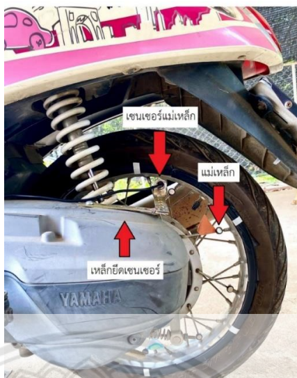
รูปที่ 3.17 การติดตั้งเซนเซอร์ตรวจจับแม่เหล็กที่ล้อหลัง
