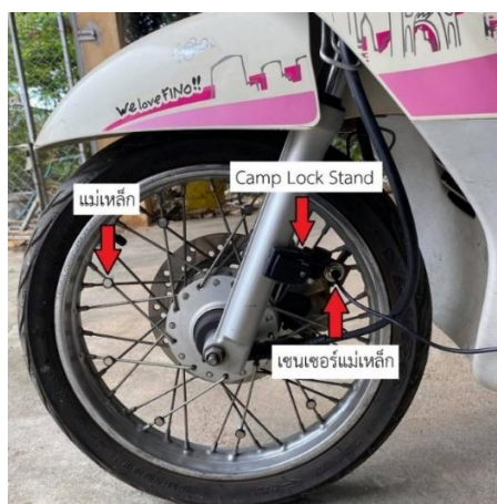
รูปที่ 3.14 การติดตั้งเซนเซอร์ที่ล้อหน้า
