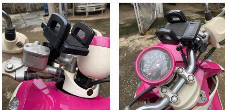
รูปที่ 3.5 การติดตั้งที่ยึดแฮนด์รถ
