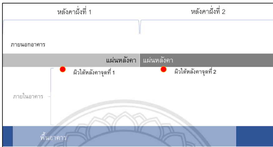
รูปที่ 4.6 การติดตั้ง Thermocouple ในการทดสอบผิวใต้หลังคาเปล่า
