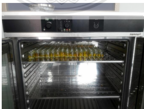
รูปภาคผนวก ง.3 ภาพแสดงการนำน้ำมันงาดำอบไล่ความชื้นที่อุณหภูมิ 60 องศาเซลเซียส
