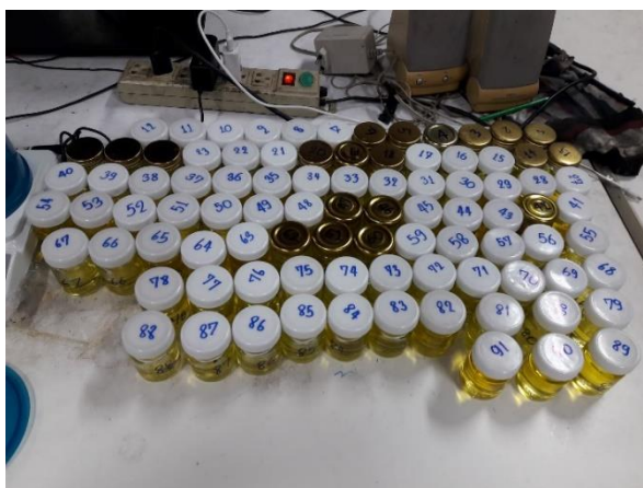
รูปภาคผนวก ง.1 ภาพแสดงการเตรียมน้ำมันงาดำสกัดเย็นไปอบไล่ความชื้น
