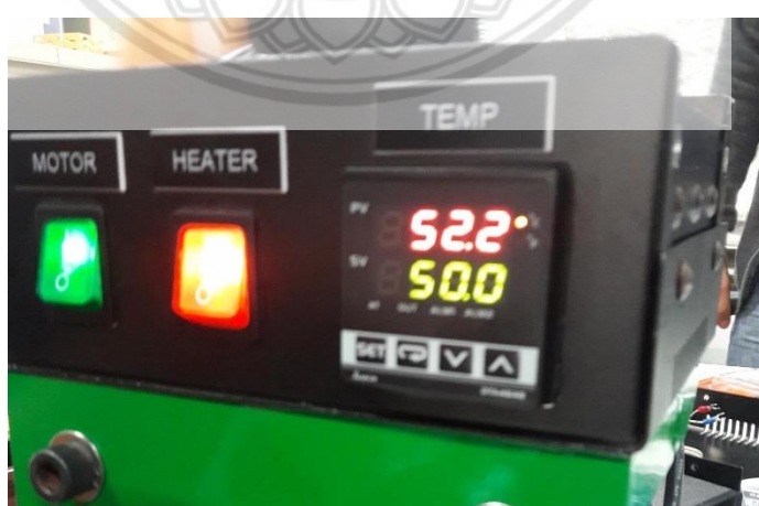
รูปที่ 3.16 ภาพประกอบการเปิดฮีตเตอร์รอจนกว่าอุณหภูมิจะได้ตามที่กำหนด และเปิดเครื่องเพื่อให้มอเตอร์ทำงาน
