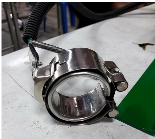
รูปที่ 3.5 ฮีตเตอร์แบบรัดท่อ (Band Heater)
