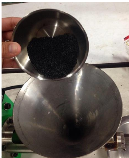
รูปภาคผนวก ข.1 ภาพแสดงการเทเมล็ดงาลงในช่องใส่วัสดุดิบ
