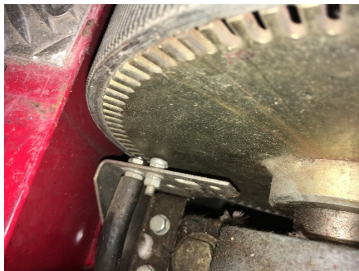
รูปที่ 2.9 แสดง Magnetic pickup sensor สำหรับไดนาโมมิเตอร์แบบ Eddy Current Brake
