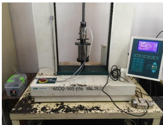
รูปที่ 3.17 ทำการอัดขึ้นรูปถ่านอัดแท่งโดยใช้เครื่อง UTM
