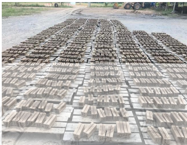
รูปที่ 2.4 ขั้นตอนนำอิฐไปตากของโรงงานอุตสาหกรรมอิฐทอโยอิฐกรุงศรี
