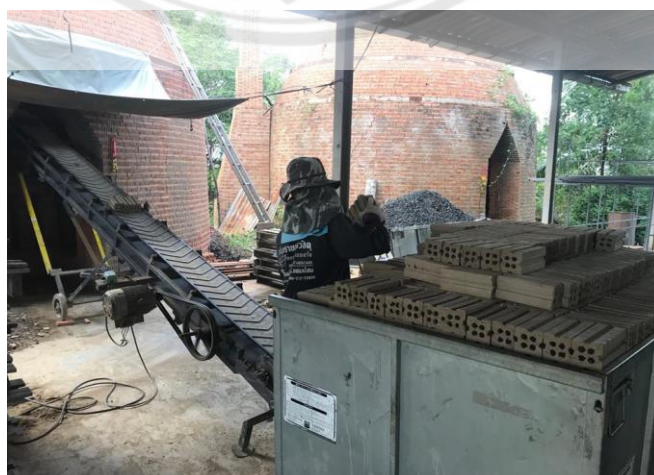
รูปที่ 2.5 ขั้นตอนการลำเรียงอิฐเข้าเตาเผาของโรงงานอุตสาหกรรมอิฐทอโยอิฐกรุงศรี
