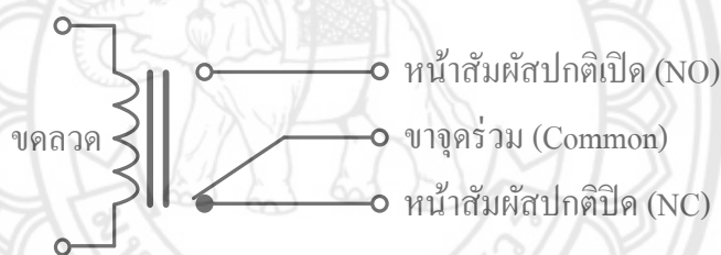
รูปที่ 2.3 สัญลักษณ์ภายในโครงสร้างของรีเลย์ (บ้านอิเล็กทรอนิกส์, 2554)
