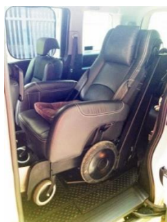
รูปที่ 2.4 ชุดแขนกลไฮดรอลิกในรถยนต์และเก้าอี้เข็น [9]
