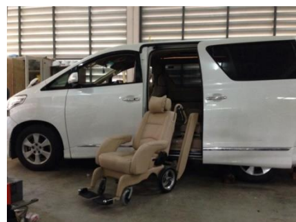
รูปที่ 2.4 ชุดแขนกลไฮดรอลิกในรถยนต์และเก้าอี้เข็น [9]
