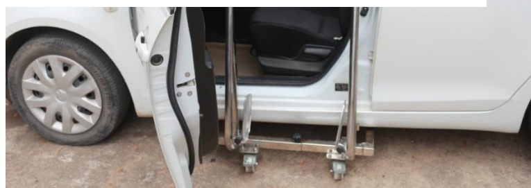
รูปที่ 4.18 โครงสร้างเก้าอี้เคลื่อนย้ายผู้ป่วยไปเทียบกับประตูลงรถ Suzuki Swift
