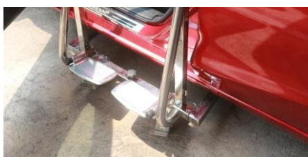
รูปที่ 4.16 โครงสร้างเก้าอี้เคลื่อนย้ายผู้ป่วยไปเทียบกับประตูลงรถ Mazda 2
