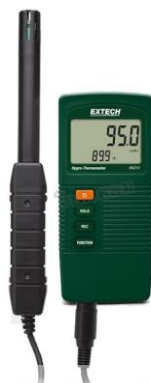
รูปที่ 3.4 เครื่องวัดอุณหภูมิและความชื้น (Hygrometer)
