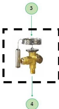
รูปที่ 2.10 การวิเคราะห์หลักการทำงานของวาล์วลดความดัน (Expansion Valve)
