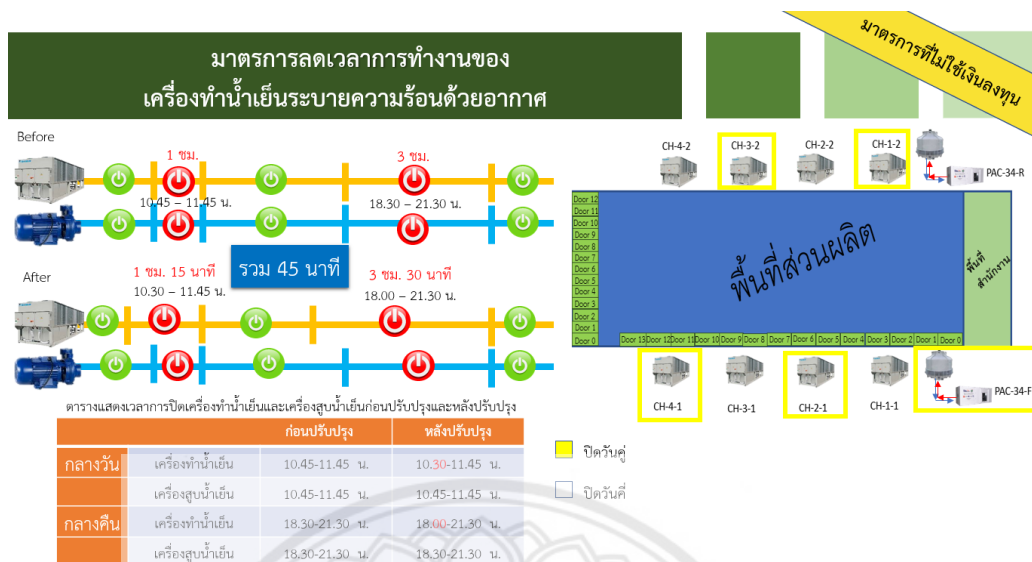
รูปที่ 4.8 มาตรการลดเวลาการทำงานของเครื่องสูบน้ำเย็นระบายความร้อนด้วยอากาศ
