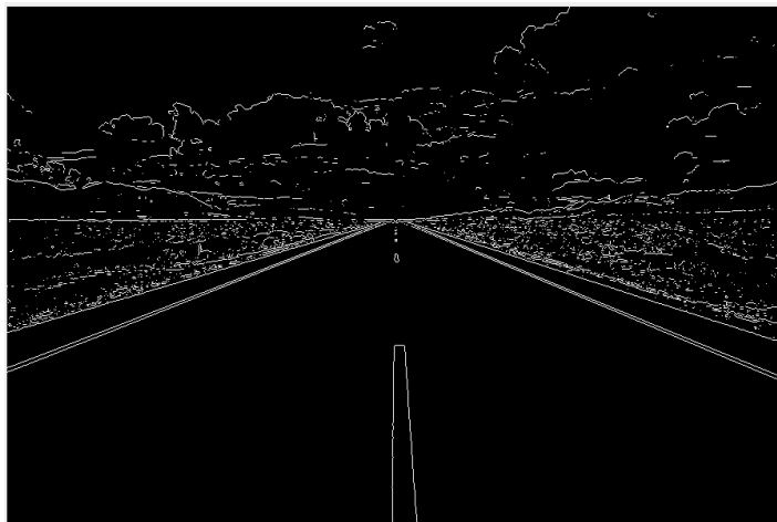
รูปที่ 2.19 ภาพที่ได้ออกมาหลังจากผ่านกระบวนการ sobel
