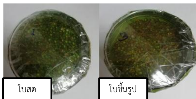
รูปที่ 4.11 ผลการทดลองการซึมน้ำของใบทองกวาวสดและใบทองกวาวชิ้นรูป
