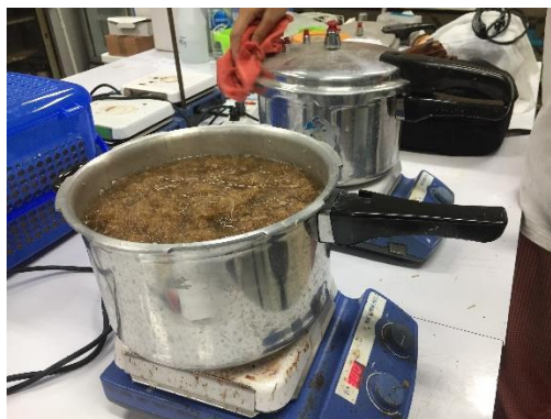
รูป ก. 8 นำเยื่อที่ได้จากการปั่นในครั้งแรกไปต้มด้วยน้ำที่อุณหภูมิ 100 องศาเซลเซียส เป็นเวลา 2 ชั่วโมง
