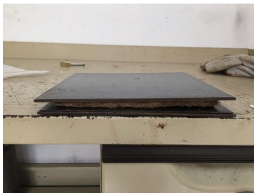
รูป ก. 25 นำแผ่นเหล็กแผ่นที่สองวางทับลงบนแผ่นชิ้นงานเพื่อไม่ให้ชิ้นงานสัมผัสกับเครื่องกดอัดไฮดรอลิกโดยตรง
