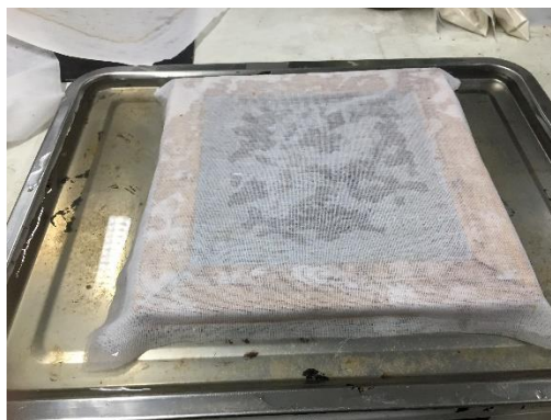
รูป ก. 13 นำผ้าขาวบางที่มีรูปทรงสี่เหลี่ยมจัตุรัสมาวางซ้อนทับแม่พิมพ์ชิ้นงานชั้นที่สอง
