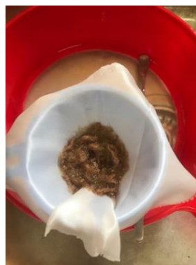
รูป ก. 40 นำไปกรองด้วยผ้ากรองแล้วล้างด้วยน้ำเปล่าปริมาณ 2,500 มิลลิตร จนกระทั่งหมดฟอง และล้างด้วยอะซิโตนปริมาณ 20 มิลลิตร หลังจากนั้นล้างต่อด้วยน้ำสะอาด 250 มิลลิตร
