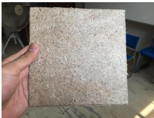
รูป ก. 31 นำชิ้นงานที่ได้ไปชั่งน้ำหนัก บันทึกผล และทำการตัดขอบส่วนเกินออก
