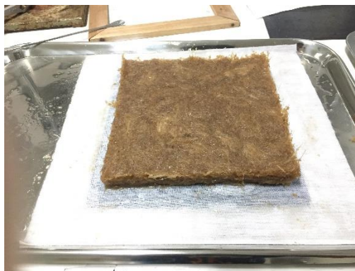
รูป ก. 16 นำแม่พิมพ์ชิ้นงานอันแรกและอันที่สองออก จะได้เยื่อกล้วยที่มีลักษณะเป็นแผ่นชิ้นงานวางซ้อนทับอยู่บนแผ่นเหล็กแผ่นแรก
