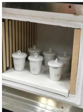
รูป ก. 46 นำตัวอย่างที่ผ่านการอบ เข้าเตาเผา และเผาที่อุณหภูมิ 500 องศาเซลเซียสโดยใช้เวลา 24 ชั่วโมงแล้ว
