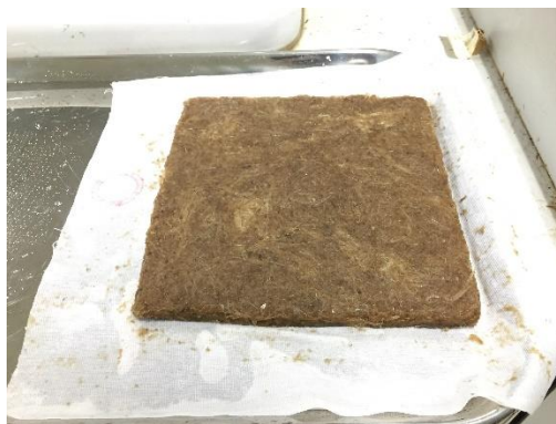
รูป ก. 19 เมื่อกดรีดเอาน้ำออกแล้ว จากนั้นนำแผ่นเหล็กและผ้าขาวบางที่อยู่ด้านบนสุดออก
