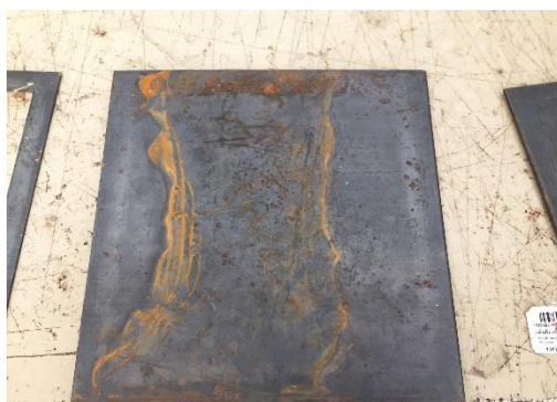
รูป ก. 22 นำแผ่นเหล็กแผ่นแรกมาวางเพื่อรองชิ้นงานที่จะนำมากดอัด
