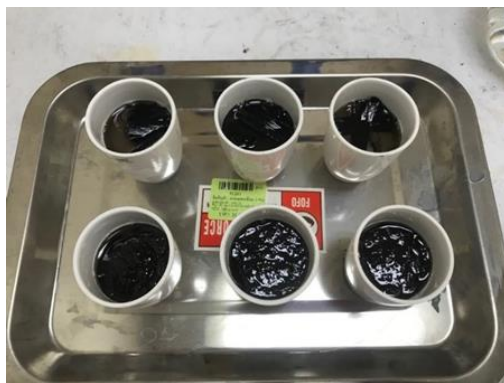
รูป ก. 43 นำตัวอย่างที่ผ่านการทำ ADF มาใส่ กูช ครูซีเบล แล้วเติม 72% กรดซัลฟิวริก ปริมาตร 40 มิลลิลิตร ลงในกูช ครูซีเบล แล้วใช้แท่งแก้วคน ตั้งทิ้งไว้ 3 ชั่วโมง นำมากรองแล้ว ล้างด้วยอะซิ-โตนปริมาตร 20 มิลลิลิตร แล้วล้างต่อด้วยน้ำเปล่า ปริมาตร 200 มิลลิลิตร
