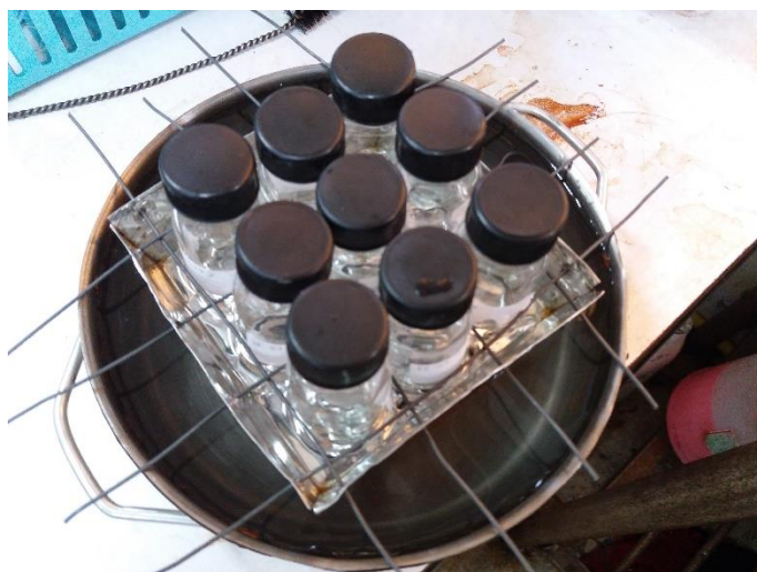
รูปที่ ค.9 อุปกรณ์ระเหยตัวทำละลายออกจากน้ำมันในอ่างควบคุมอุณหภูมิ
