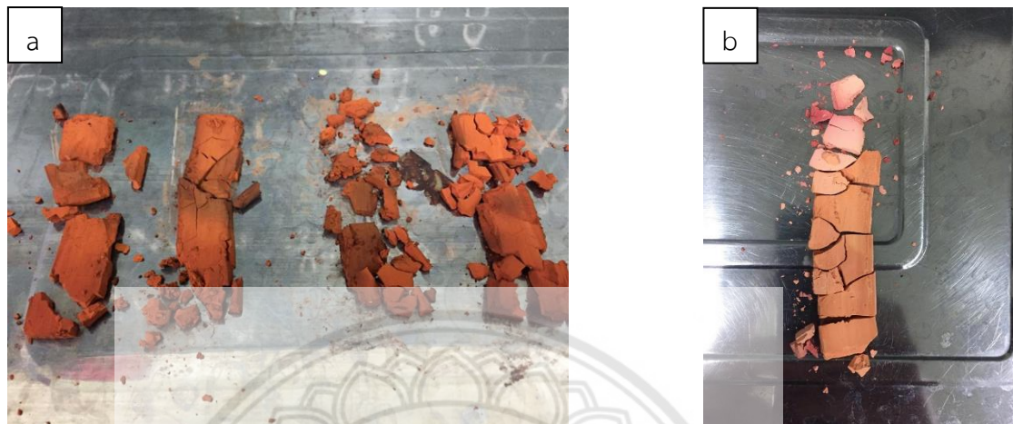
รูปที่ 4.1 ลักษณะของซีวีเล็กโทรดที่อัตราส่วนต่างๆ RF: \text{TiO}_2 a) 1:1 และ b) 1:2
