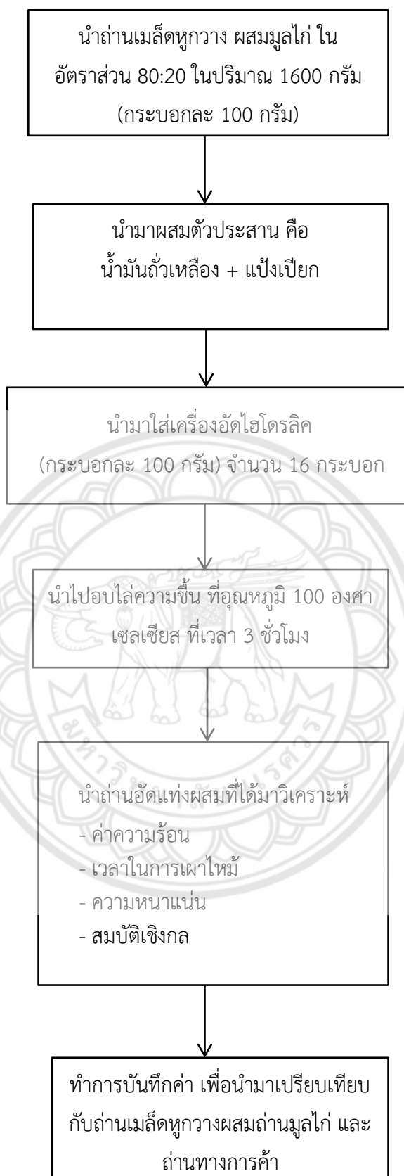
รูปที่ 3.12 การผสมถ่านเมล็ดทุกวาง และมูลไก่
