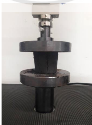
รูปที่ 3.25 ถ่านซีวมวลหลังการทดสอบการต้านทานแรงกด
