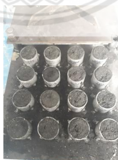
รูปที่ 3.20 ผงถ่านที่ผสมแล้วเตรียมอัดขึ้นรูป
