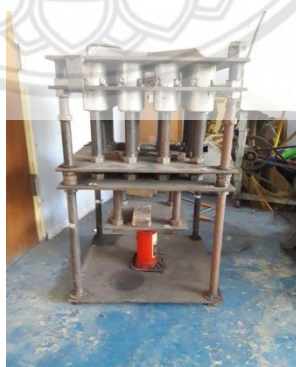
รูปที่ 3.4 เครื่องอัดระบบไฮดรอลิก (ชัยบดินทร์ และพีระศักดิ์, 2554)
