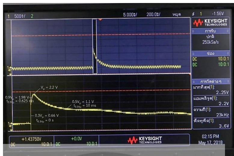
รูปที่ 4.8 รูปคลื่นอิมพัลส์จากการทดสอบเบรกดาวน์ผ่านอากาศไปตามผิวของน้ำครั้งที่ 1 (ภาคผนวก ง)
