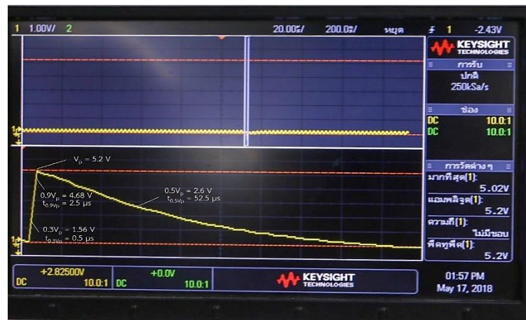
รูปที่ ค.4 รูปคลื่นอิมพัลส์จากการทดสอบเบรกดาวน์ผ่านอากาศครั้งที่ 4
