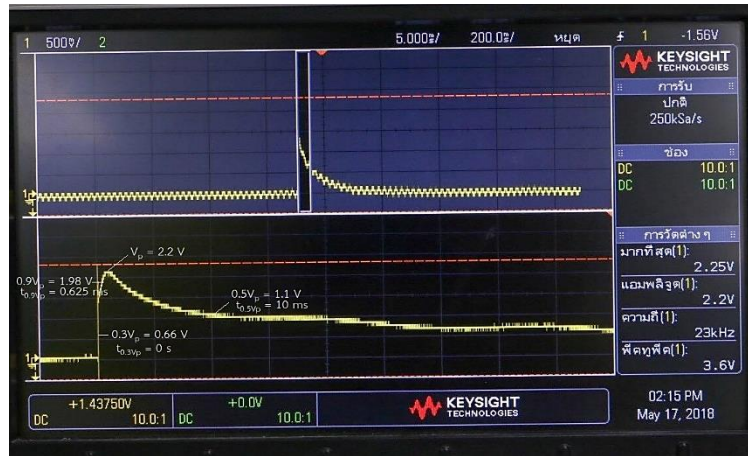
รูปที่ ง.1 รูปคลื่นอิมพัลส์จากการทดสอบเบรกดาวน์ผ่านอากาศไปตามผิวของน้ำครั้งที่ 1
