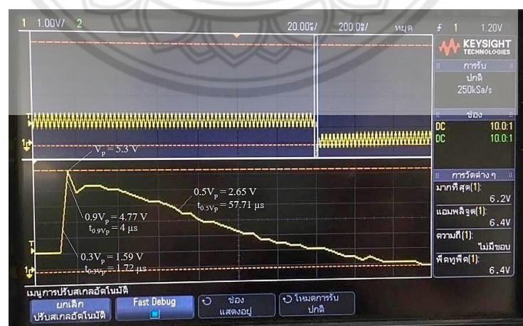
รูปที่ ข.12 รูปคลื่นของแรงดันอัดประจุขั้นที่ 8 ครั้งที่ 1
