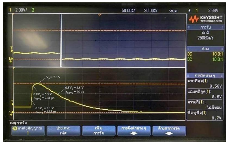
รูปที่ ข.16 รูปคลื่นของแรงดันอัดประจุขั้นที่ 10 ครั้งที่ 1
