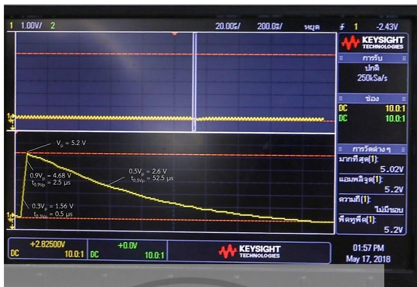
รูปที่ 4.5 รูปคลื่นอิมพัลส์จากการทดสอบเบรกดาวนผ่านอากาศครั้งที่ 4 (ภาคผนวก ค)
