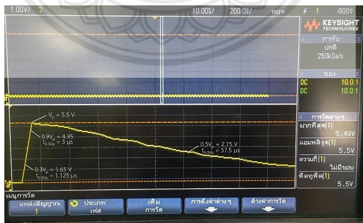
รูปที่ ค.3 รูปคลื่นอิมพัลส์จากการทดสอบเบรกดาวน์ผ่านอากาศครั้งที่ 3
