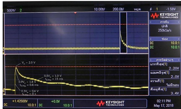
รูปที่ ง.4 รูปคลื่นอิมพัลส์จากการทดสอบเบรกดาวน์ผ่านอากาศไปตามผิวของน้ำครั้งที่ 4
