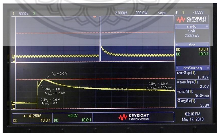
รูปที่ ง.3 รูปคลื่นอิมพัลส์จากการทดสอบเบรกดาวน์ผ่านอากาศไปตามผิวของน้ำครั้งที่ 3
