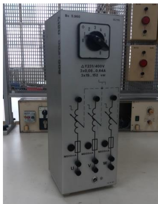
รูปที่ 3.38 ตัวเหนี่ยวนำของ ELWE รุ่น Bs 5.960 สามารถปรับค่าความเหนี่ยวนำได้ 8 ระดับ
