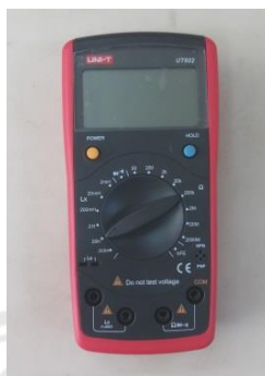
รูปที่ 2.29 RLC Meter ของ UNI-T รุ่น UT602
