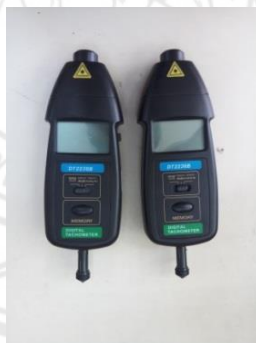
รูปที่ 2.30 เครื่องมือวัดความเร็วรอบ (Digital tachometer รุ่น DT2236B)
