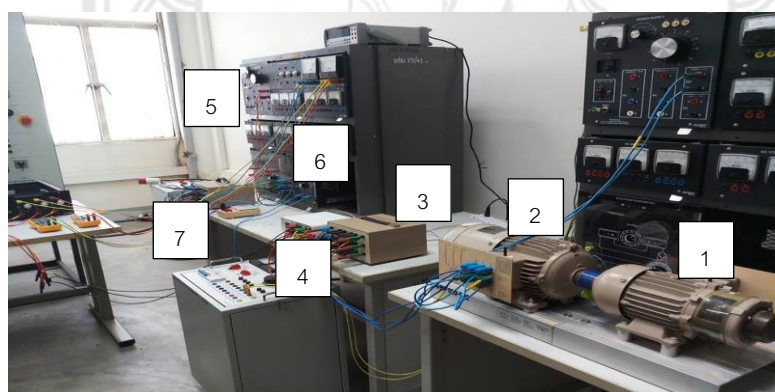
รูปที่ 4.3 รูปการเชื่อมต่อเครื่องกำเนิดไฟฟ้าแบบซิงโครไนส์ 2 ตัว เข้าสู่ระบบไฟฟ้า
