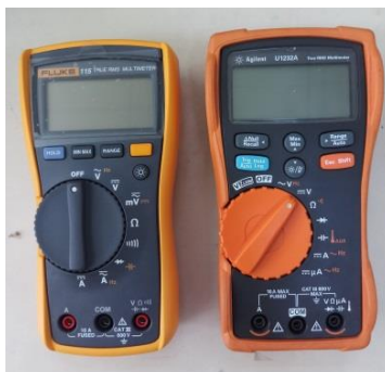
รูปที่ 2.26 ดิจิตอลมิเตอร์แบบพกพา FLUKE รุ่น 115 TRUE RMS MULTIMETER (ซ้าย) , ดิจิตอลมิเตอร์แบบพกพา AGILENT รุ่น 1232A TRUE RMS MULTIMETER (ขวา)
