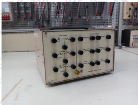
รูปที่ 2.22 หม้อแปลง (Transformer)
