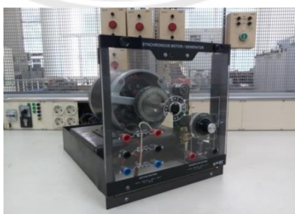
รูปที่ 2.19 เครื่องกำเนิดไฟฟ้าแบบซิงโครนัส 3 เฟส (Lab volt)
