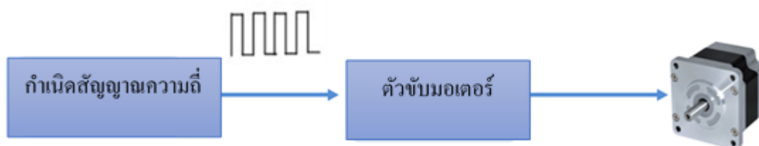
รูปที่ 2.8 แผงผังการทำงานของมอเตอร์สเต็ปเปอร์
