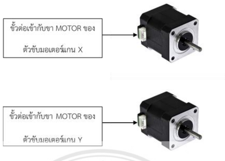
รูปที่ 2.9 แผนภาพการเชื่อมต่อใช้งานของมอเตอร์สแต็ปเปอร์แกนต่าง ๆ
