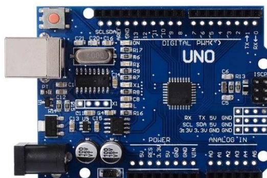
รูปที่ 2.2 แผงวงจรอาดูโน่รุ่น UNO R3
