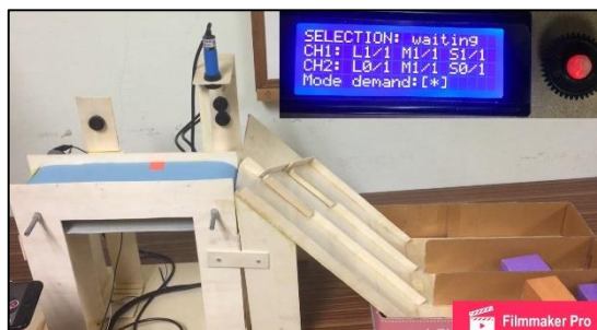
รูปที่ 4.11 การตรวจไม่พบวัตถุในขณะที่จำนวนวัตถุยังไม่ครบตามเงื่อนไข
