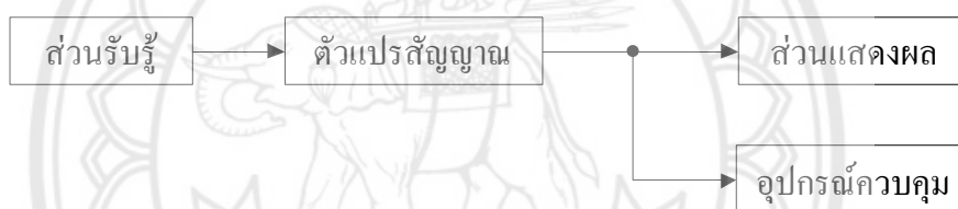
รูปที่ 2.4 แผนภาพการใช้งานตัวรับรู้ (สมาร์ทเลิร์นนิ่ง, 2552)
