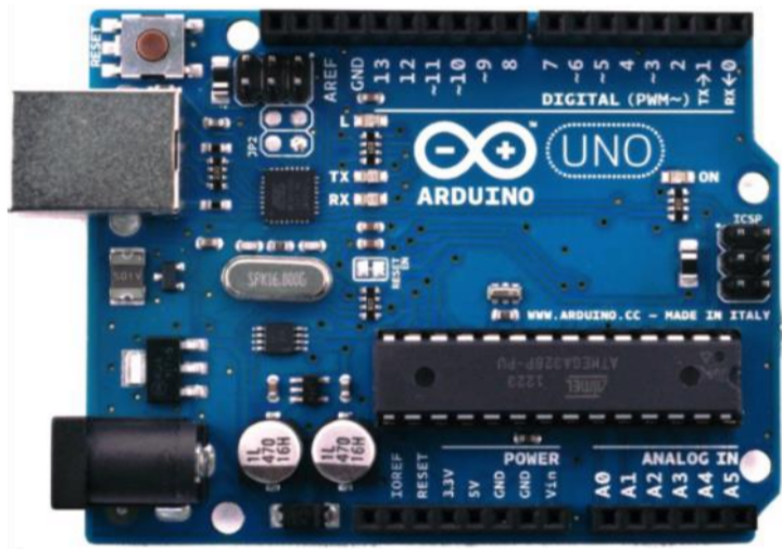
รูปที่ 2.1 แผงวงจร Arduino รุ่น Uno R3 (Arduino, 2017)
