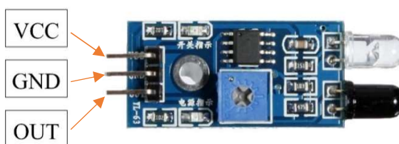
รูปที่ 3.8 โมดูลตรวจจับเส้นและสิ่งกีดขวางแบบอินฟราเรด
