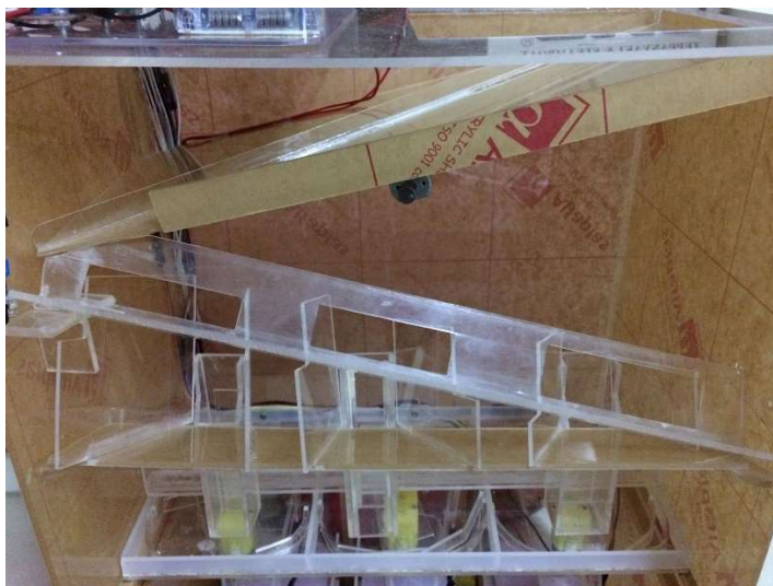
รูปที่ 3.3 ส่วนไว้สำหรับใส่เหรียญและแยกเหรียญ
