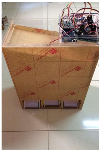
รูปที่ 3.2 โครงสร้างเครื่องนับและบรรจุเหรียญ
