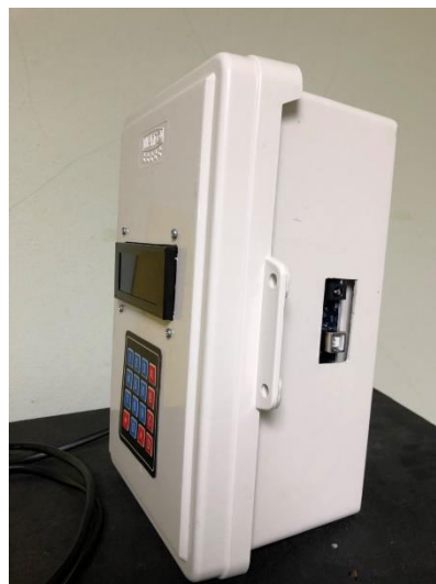
(ก) การติดตั้งจอแอลซีดีและแป้นตัวเลข (ข) ช่องจ่ายไฟเลี้ยงไมโครคอนโทรลเลอร์
