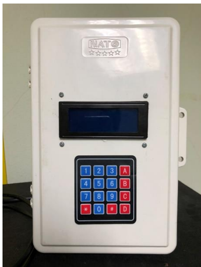
(ก) การติดตั้งจอแอลซีดีและแป้นตัวเลข (ข) ช่องจ่ายไฟเลี้ยงไมโครคอนโทรลเลอร์
