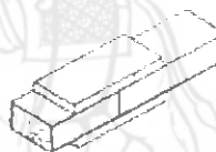
ภาพที่ 2.14 การต่อชนแบบต่อตาม (มนตรี และศิริรัตน์. งานช่าง, 2548 : 112)
