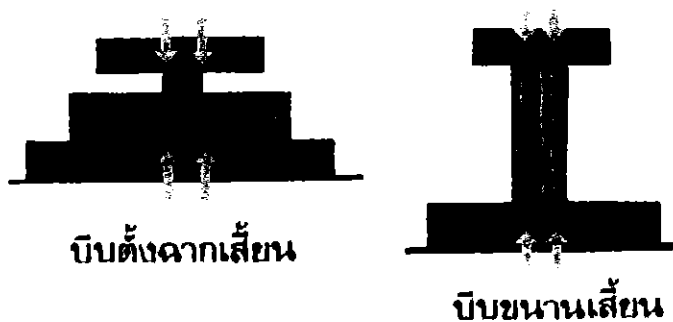
ภาพที่ 3.6 ภาพการทดลองหาค่ากลสมบัติของไม้
