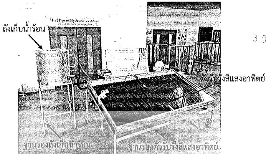
รูปที่ 3.19 แสดงภาพจริงของเครื่องทำน้ำร้อนพลังงานแสงอาทิตย์แบบแผ่นเรียบที่ใช้ท่อความร้อนแบบสั่นง่วงรอบที่ระบบน้ำให้หลวมตามธรรมชาติ
