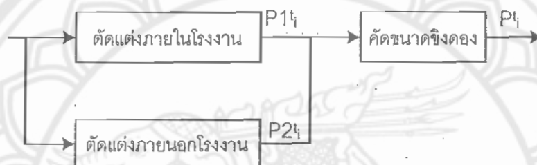
รูปที่ 4.6 แสดงขอบเขตของโปรแกรมการวางแผนการผลิตซิงตง
