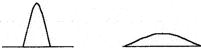
รูปที่ 2.7 ความแปรปรวนมีค่าเล็ก และความแปรปรวนมีค่าใหญ่
