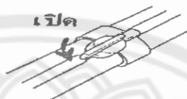
รูปที่ 2.39 การเปิดวาล์วท่อสารเคมี
