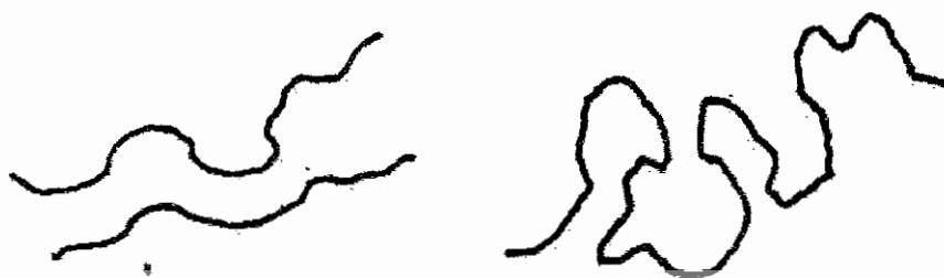
รูปที่ 2.2 โพลีเมอร์แบบเส้นยาวตลอด (Linear Shape)
