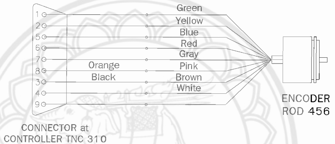
รูปที่ 4.9 แสดงการต่อ Encoder กับ Connector X1, X2, X3 ของ Controller
