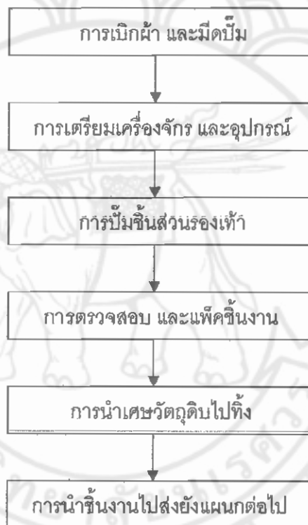
รูปที่ 4.1 ขั้นตอนการทำงานเบื้องต้น ในส่วนของการปั๊มชิ้นส่วนรองเท้า
