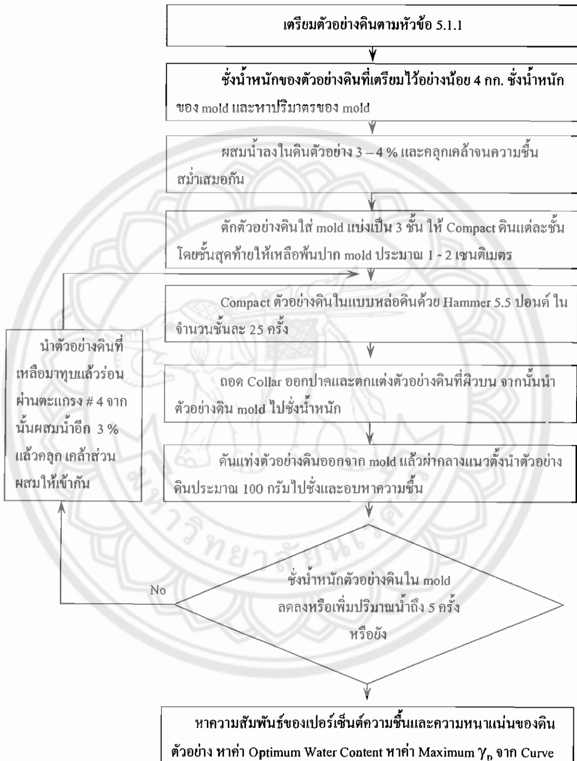
รูปที่ 10.5.10 แสดงขั้นตอนการทดสอบบดอัดดินวิธี Standard Proctor Test
