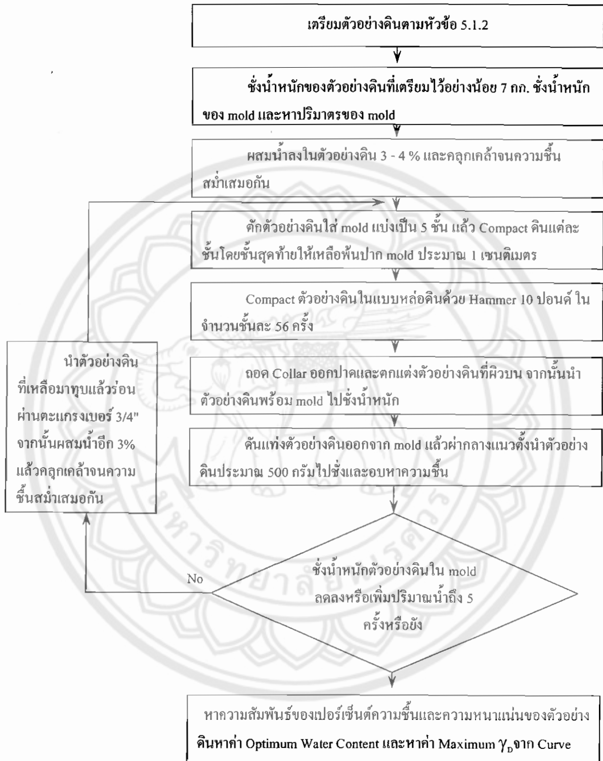
รูปที่ 10.5.11 แสดงขั้นตอนการทดสอบบดอัดดินวิธี Modified Proctor Test
