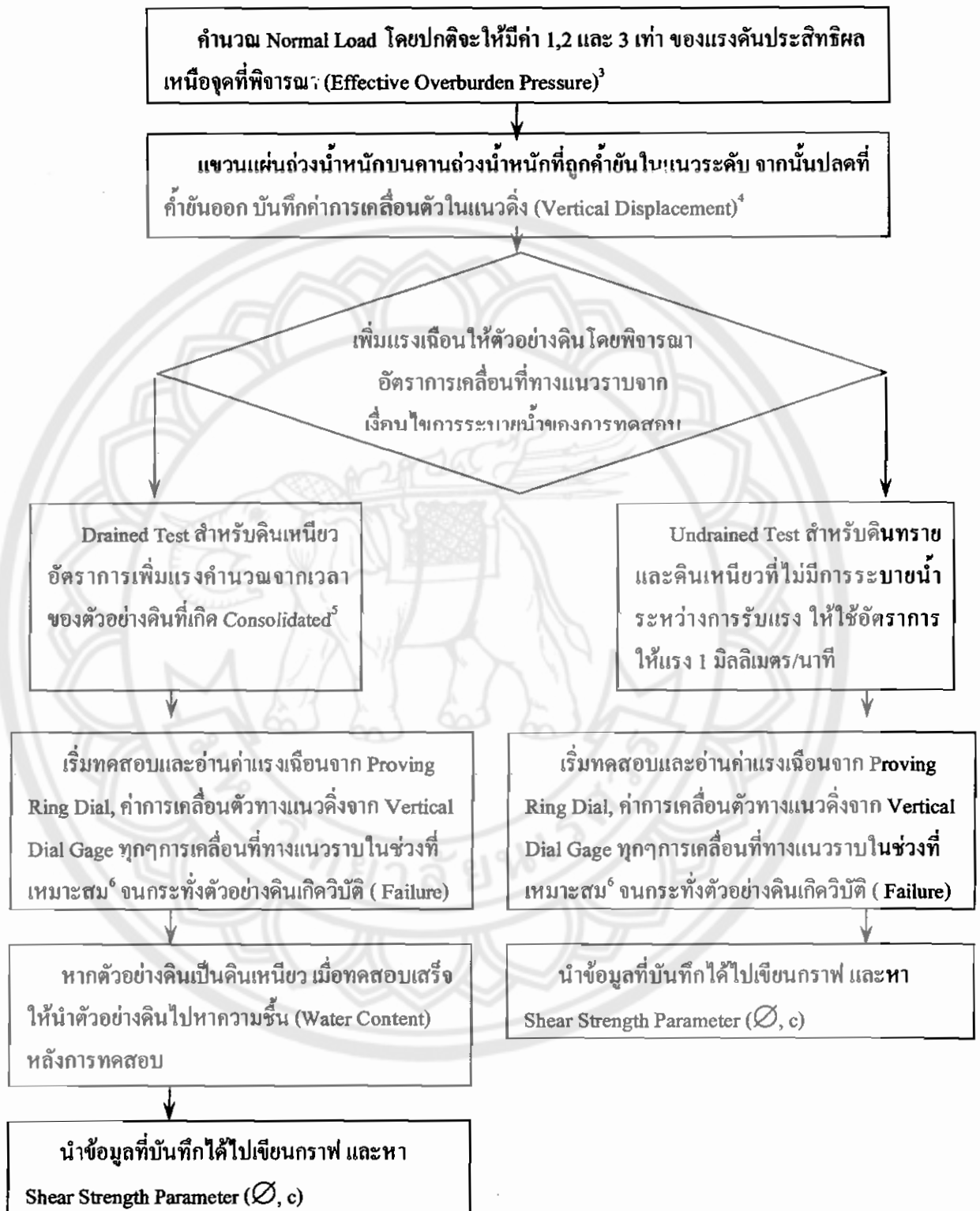
รูปที่ 10.10.9 ขั้นตอนการทดสอบ Direct Shear
