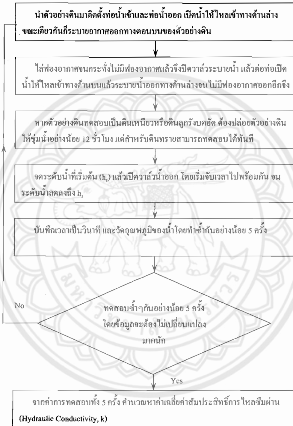
รูปที่ 10.8.4 แสดงขั้นตอนการทดสอบแบบระดับน้ำแปรเปลี่ยน (Falling Head Test)
