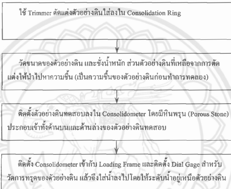
รูปที่ 10.11.4 แสดงขั้นตอนการเตรียมตัวอย่างดิน
