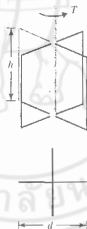
รูปที่ 9.29 แผนภาพแสดงใบมีดที่ใช้ทดสอบ Vane Shear Test
