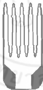
รูปที่ A5 เครื่องวัดความเครียดไฟฟ้า ( Electrical strain gage )
