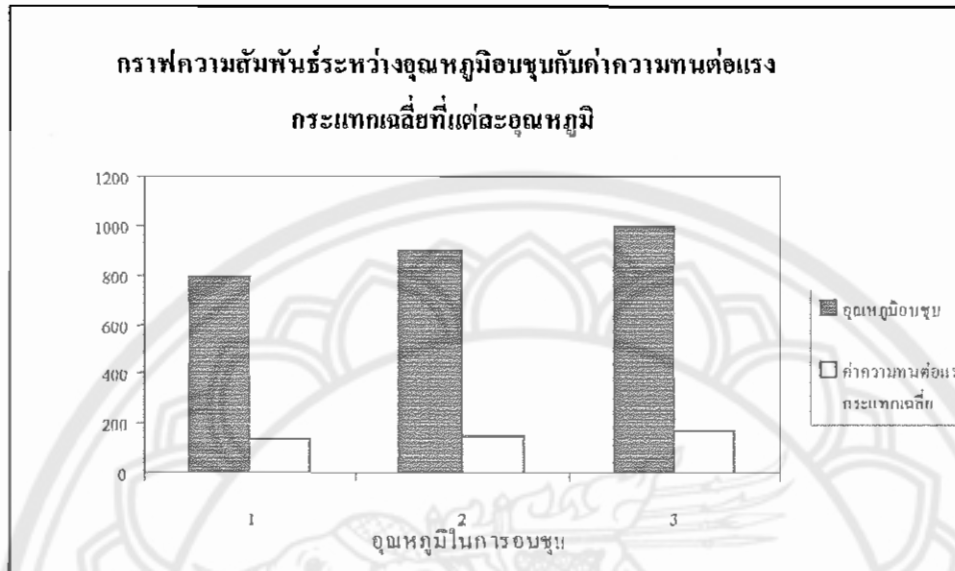
รูปที่ 5.6 กราฟความสัมพันธ์ระหว่างอุณหภูมิอบชุบกับ ค่าความทนต่อแรงกระแทกเฉลี่ยของแต่ละอุณหภูมิ
